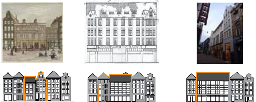
het reliëf is verdwenen doordat percelen zijn samengevoegd
